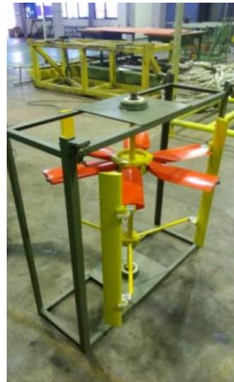
Gambar 3. Model uji turbin kombinasi
